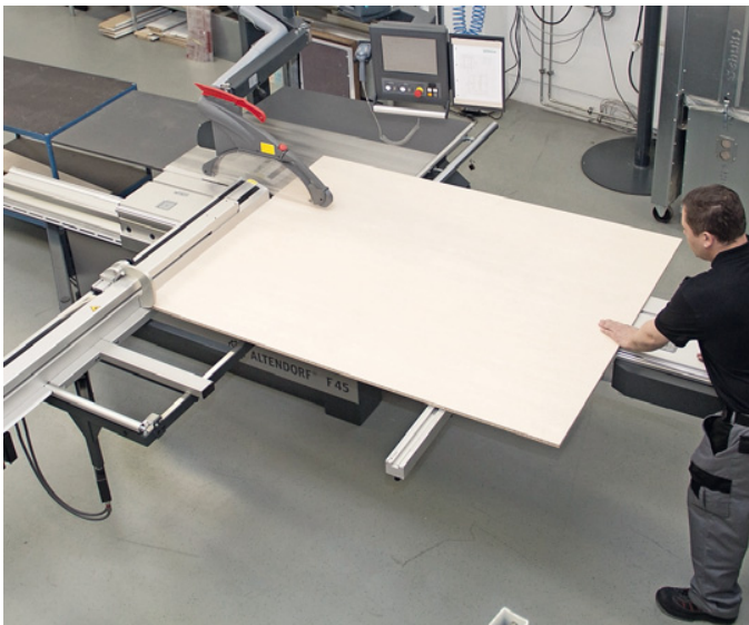
Die CNC-Klappe ermöglicht Parallelschnitte am Winkelanschlag
