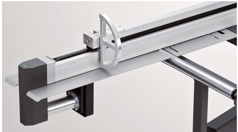
/ Ebenfalls neu ist der CNC-gesteuerte Winkelanschlag Uno 90. Er ist in der 90°-Position fixiert und ermöglicht das präzise Ablängen von Strängen sowie das exakte Formatieren von Platten.
